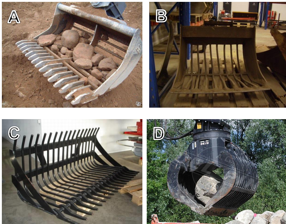
Figur 8: Eksempler af mulige sorteringsapparater. Foto A viser en stengreb monteret på en gravemaskine. Foto B viser en risteskovl, som kan monteres på en gravemaskine. Foto C viser en stengreb, som kan monteres på en gummiged. Foto D viser en sorteringsgrab monteret på en gravemaskine.
